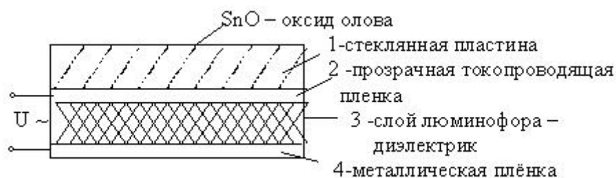
Рис. 6.2. Структура электролюминесцентного индикатора:
